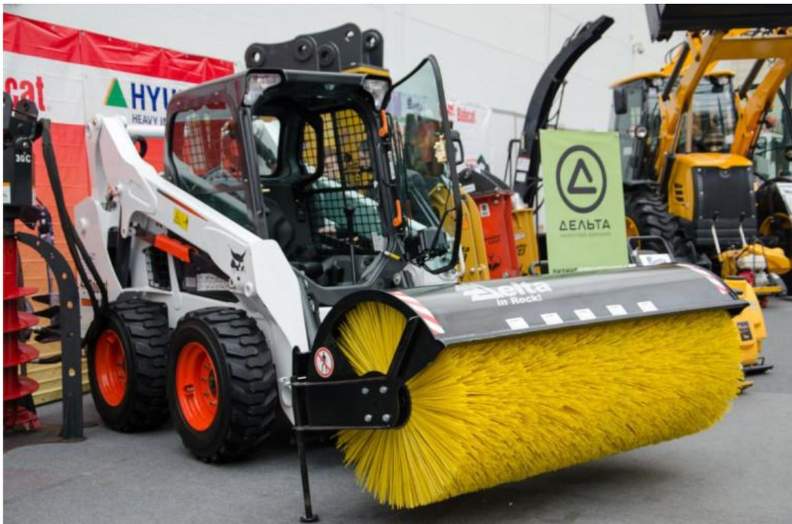
Работать погрузчик может в условиях ограниченного пространства за счет небольших габаритов и возможности осуществлять бортовой поворот. Стрела, устанавливаемая на машину, поднимается по вертикали и позволяет осуществлять любые типы погрузочных работ.
